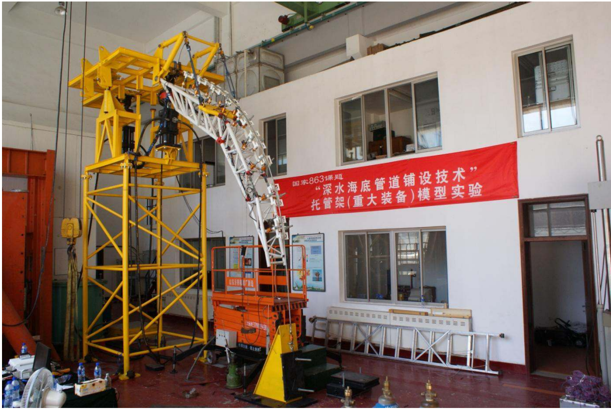
图9：“深水海底管道铺设技术”模型实验
